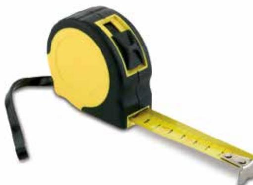
Flessometro con nastro millimetrato ad alta visibilità, auto-avvolgente a molla, cursore di blocco, cassa in plastica rivettata in gomma antiscivolo, clip di aggancio.
